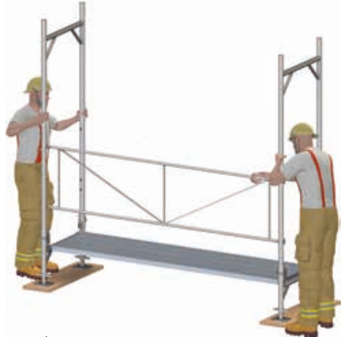
Şekil 3: İlk iskele alanının kurulumu.
