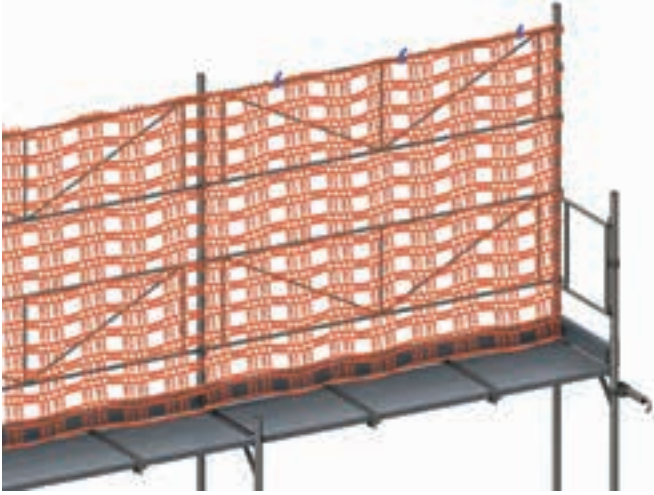
Şekil 33: Güvenlik ağılarının tasarımı. (Güvenlik ağıları için ayrı kurulum talimatlarına bakınız.)
