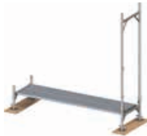
Şekil 16: İskele çerçevesinin takılması.
