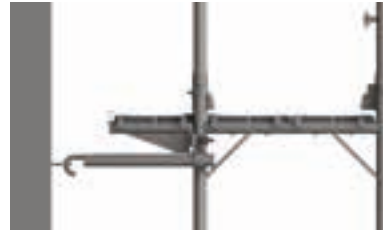
Şekil 24: İskele desteği, iç braketler ile yapılandırma.
