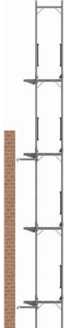
Şekil 43: Binaların montajı sırasında bir ara durum olarak serbest duran iskele bölmesi.
