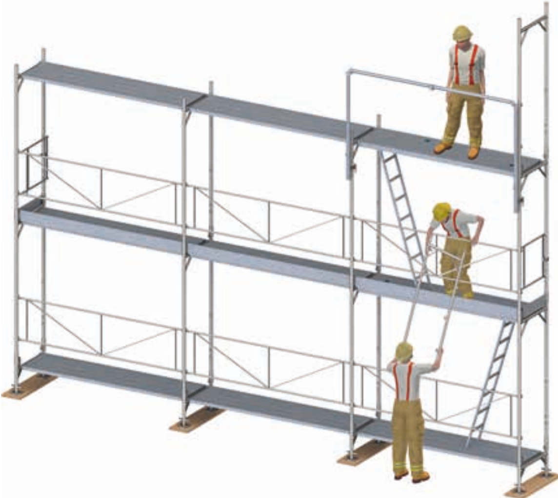
Şekil 13: Üst iskele bölümünde malzeme alımı ve iskele montaj örneği.
